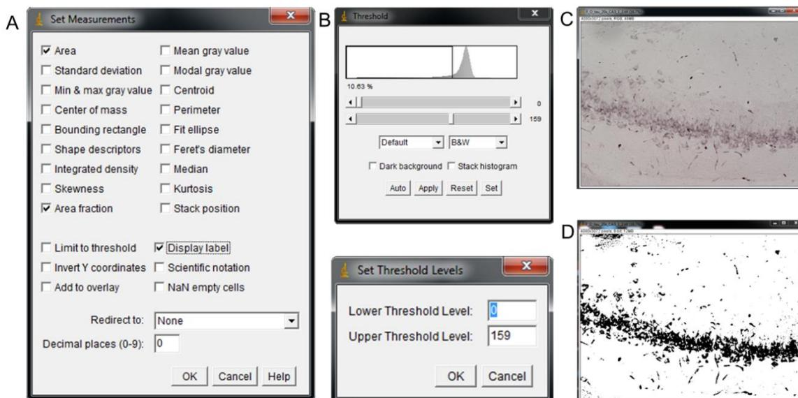
**Slika 4.7.2.1** Primjer korištenja zadanih naredbi u računalnom programu Fiji. (A) Određivanje osnovnih parametara mjerena te raspona vrijednosti piksela za 8-bitnu sliku (B), neizmijenjena slika (C) i obrađena slika (D).
