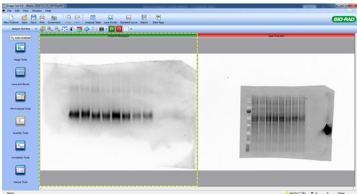
**Slika 4.7.5.4.** Prikaz sučelja ImageLab 6.0 računalnog programa te izgleda pripremljenih slika za obradu. Na lijevoj je strani primjer pojedinačno analiziranih proteinskih vrpci neuroplastina, a na desnoj primjer ukupnih proteina na istoj PVDF membrani.
