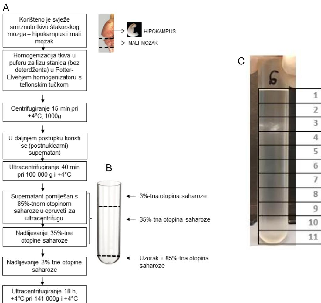
**Slika 4.7.4.1.** Shema izolacije lipidnih splavi (A), dizajn gradijenta saharoze (B), prikaz krajnjeg rezultata – epruveta s lipidnim splavima vidljivima u obliku oblačića u frakcijama 3 i 4 te nesplavima u frakcijama 10 i 11 (C).
