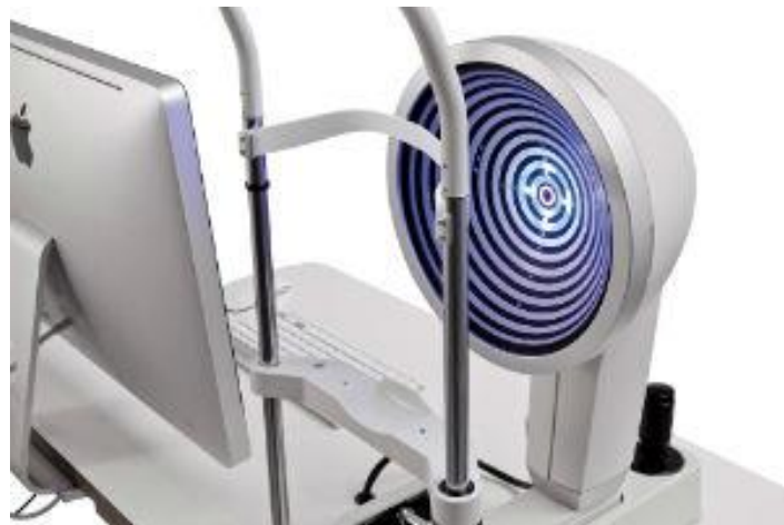
Slika 5. Mjerenje NIBUT-a videokeratoskopijom. Uređaj Oculus Keratograph 5M projicira sliku koncentričnih krugova na površinu suznog filma. (145)
