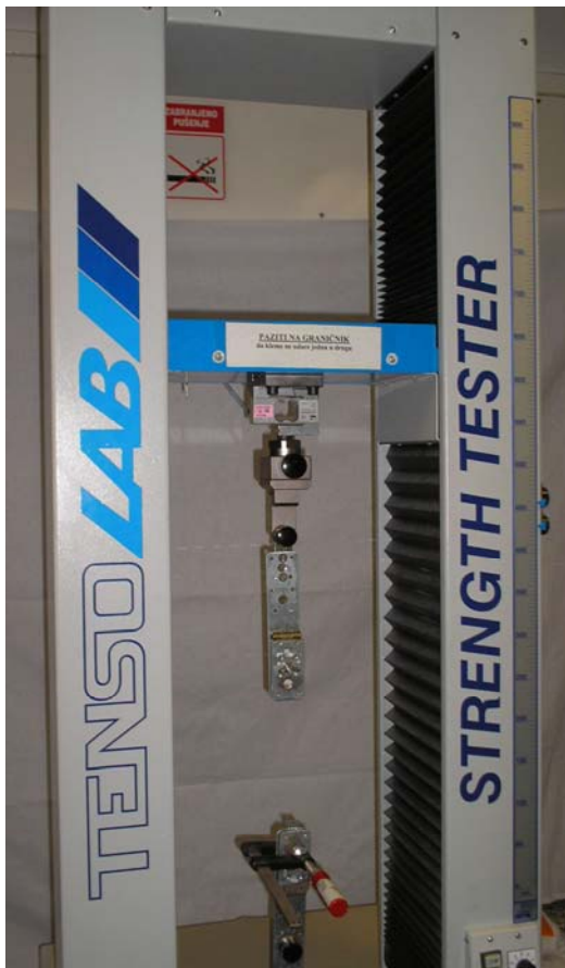
Slika 8. Fotografija numeričke kidalice (TENSO-LAB, STRENGTH TESTER, Mesdan Lab., Raffa di Puegnago, Italija) na kojoj je i načinjeno biomehaničko testiranje za potrebe ovog istraživanja i koja se nalazi u MIRTA-KONTROL, d.o.o., Zajčeva 23, Zagreb, Hrvatska. Fotografija je snimljena pomoću digitalnog fotoaparata Canon DIGITAL IXUS II.
