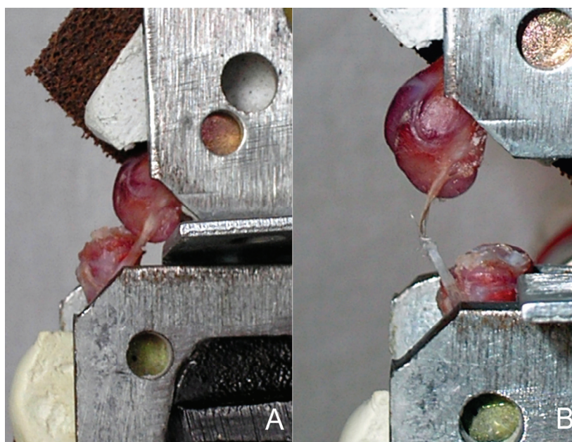
Slika 31. A) Preparat kost-ligament-kost (femur-medijalni kolateralni ligament-tibija) postavljen u pritezne ploče koje su uklještene u posebne metalne stezaljke na početku biomehaničkog testiranja koje je načinjeno na numeričkoj kidalici (TENSO-LAB, STRENGTH TESTER, Mesdan Lab., Raffa di Puegnago, Italija) u MIRTA-KONTROL, d.o.o., Zajčeva 23, Zagreb, Hrvatska. B) Preparat kost-ligament-kost (femur-medijalni kolateralni ligament-tibija) s puknutim LCM-om po završetku testiranja. Fotografije su snimljene pomoću digitalnog fotoaparata Canon DIGITAL IXUS II.
