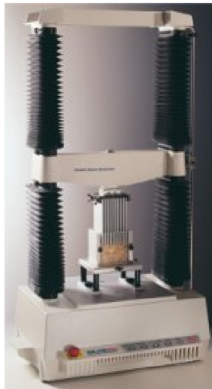
Slika 5-1. Kidalica „Universal Testing Machine, TA.HD plus“.
