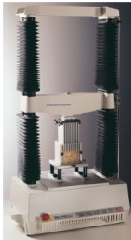
Slika 5-1. Kidalica „Universal Testing Machine, TA.HD plus“.
