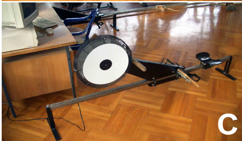
Slika 6. Suvremeni veslački ergometri: A) ergometar s fiksnim odupiračem za noge (Concept II); B) ergometar s fiksnim odupiračem za noge (Concept II) postavljen na klizače; C) ergometar s pomičnim odupiračem za noge (RowPerfect).
