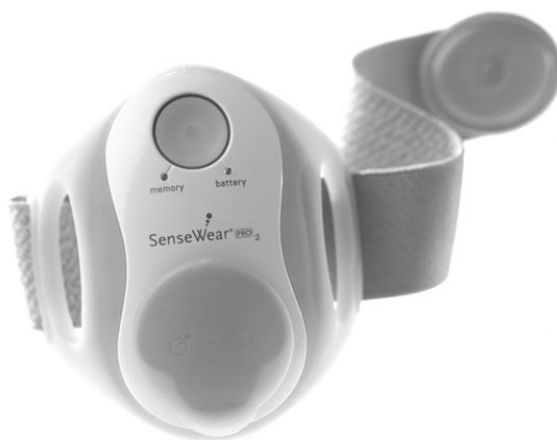
Slika 2. Sensewear Armband multi-senzorni uređaj za mjerenje tjelesne aktivnosti i utroška energije (Bodymedia Inc., Pittsburgh, SAD).
