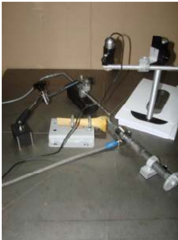
Slika 32. Oprema s kojom je provedeno ispitivanje modela na tlak
