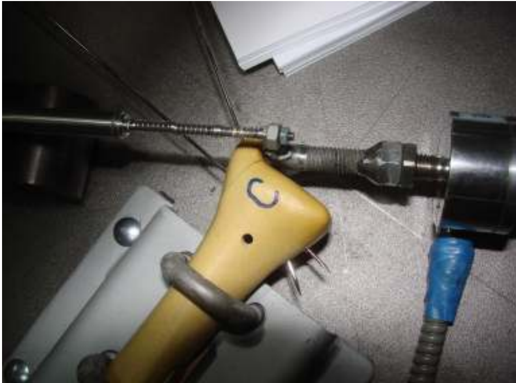
Slika 33. Djelovanje tlačne sile na unutarnju stranu modela lomnog ulomka
