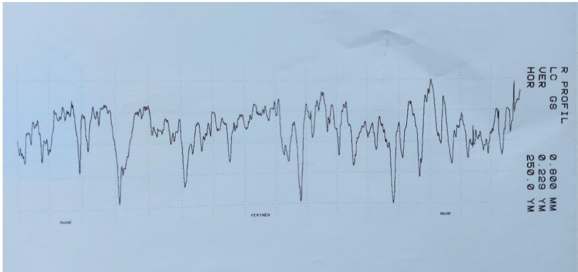
Slika 61. Najveća dubina jamice na prikazanoj slici grafa mjeri 0,229 μm
