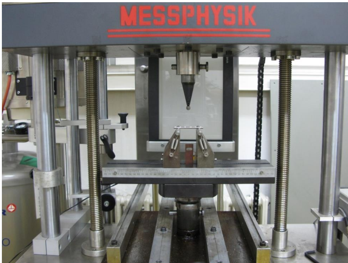
Slika 14. Eksperimentalni postav kod statičkog savijanja pločica u tri točke
