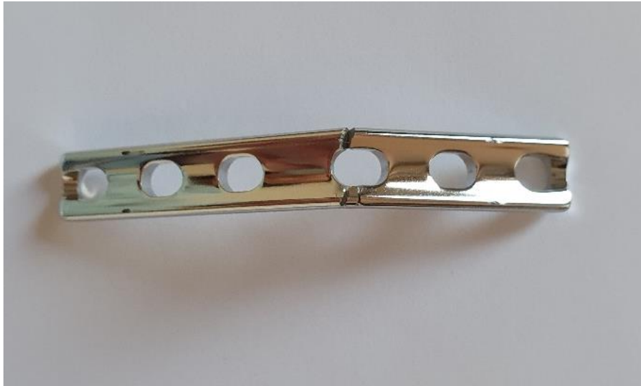
Slika 53. Ista pločica broj 17 prikazana straga (pH 6,0) po puknuću uslijed cikličkog testiranja; zorno se prikazuje mjesto loma u području otvora pločice najbližoj mjestu primjene opterećenja
