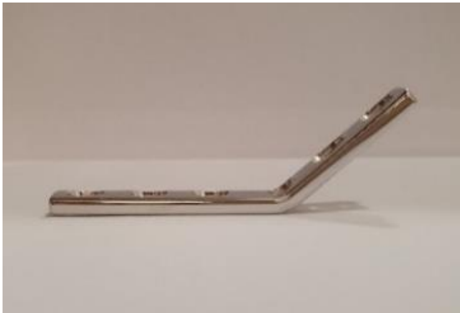
Slika 50. Pločica broj 5 iz prve skupine prikazana sa strane (pH 7,0) po puknuću uslijed cikličkog opterećenja
