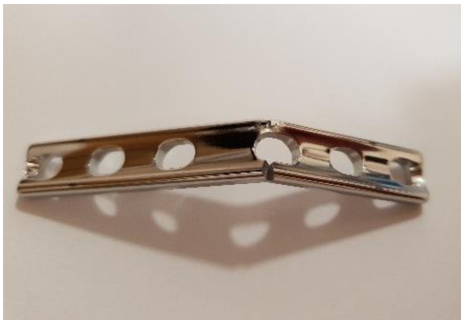
Slika 51. Ista pločica broj 5 prikazana straga (pH 7,0) po puknuću uslijed cikličkog testiranja; zorno se prikazuje mjesto loma u području otvora pločice najbližoj mjestu primjene opterećenja
