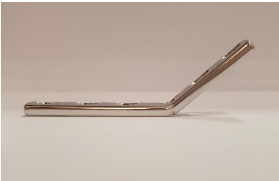
Slika 54. Pločica broj 33 iz treće skupine prikazana sa strane (pH 5,0) po puknuću uslijed cikličkog opterećenja
