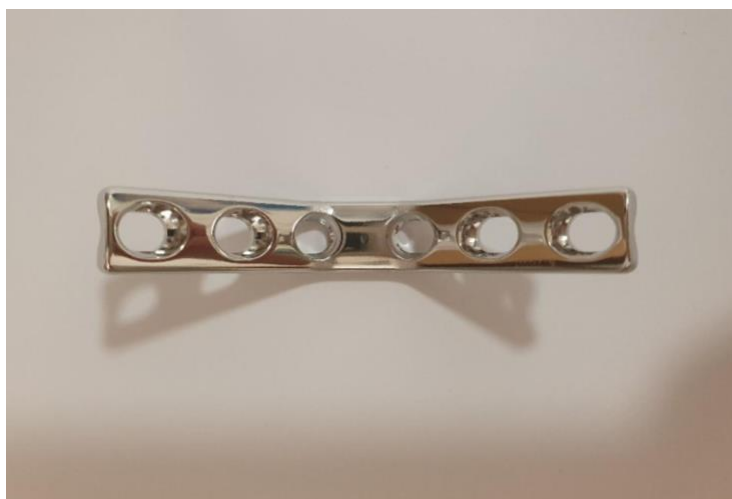
Slika 45. Pločica broj 37 iz četvrte skupine prikazana sprijeda (kontrolna skupina) po statičkom opterećenju
