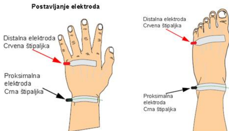
Slika 7. Postavljanje elektroda za mjerenje BIS
