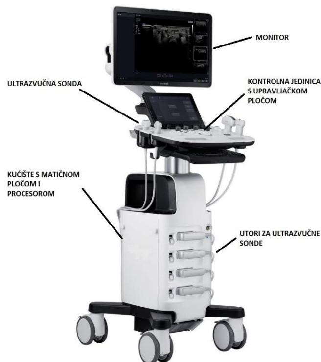
Slika 1. Prikaz ultrazvučnog uređaja sa osnovnim komponentama
