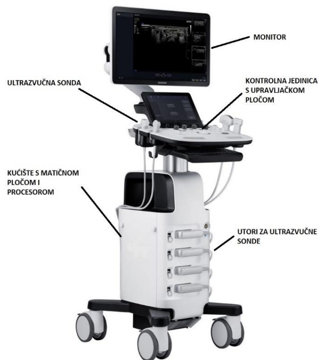
Slika 1. Prikaz ultrazvučnog uređaja sa osnovnim komponentama
