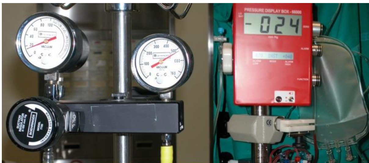
Slika 8. Prikaz sustava monitoriranja negativnog tlaka unutar venskog rezervoara prilikom korištenja VAVD procedure, preuzeto na:
