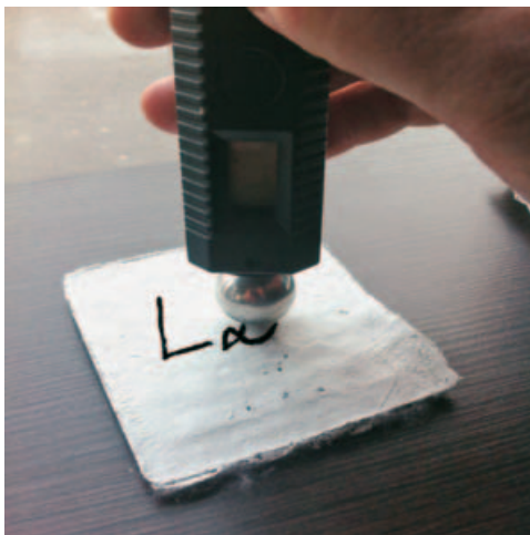
Slika 3. Određivanje vlažnosti sadrene pločice Figure 3. Determination of moisture plaster tiles
