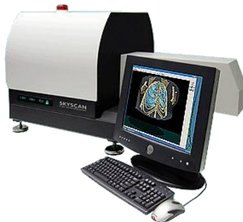
Slika 6. \mu CT uređaj 1076 tvrtke SkyScan
