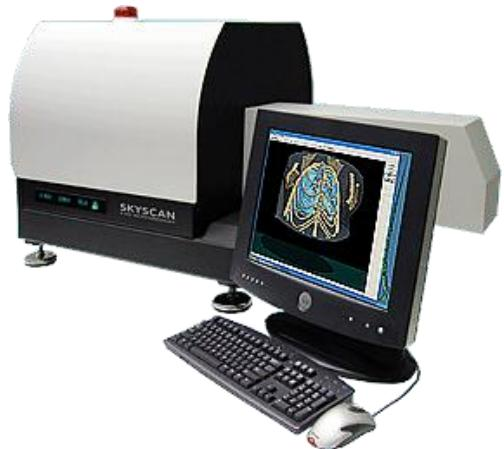
Slika 6.  $\mu$ CT uređaj 1076 tvrtke SkyScan
