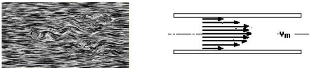
Slika 3.2.3.-2 Turbulentni protok i profil raspodjele brzina. Prema: (Brnjas-Kraljević & Krilov, 2009)
