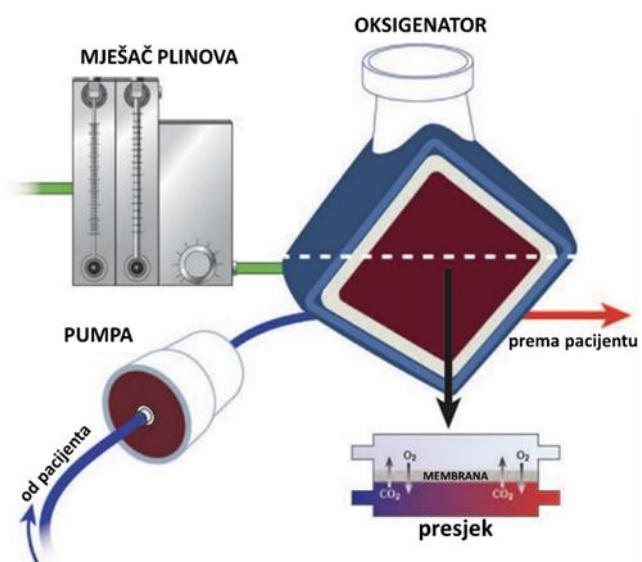
**Slika 6** Prikaz izmjene plinova u oksigenatoru
