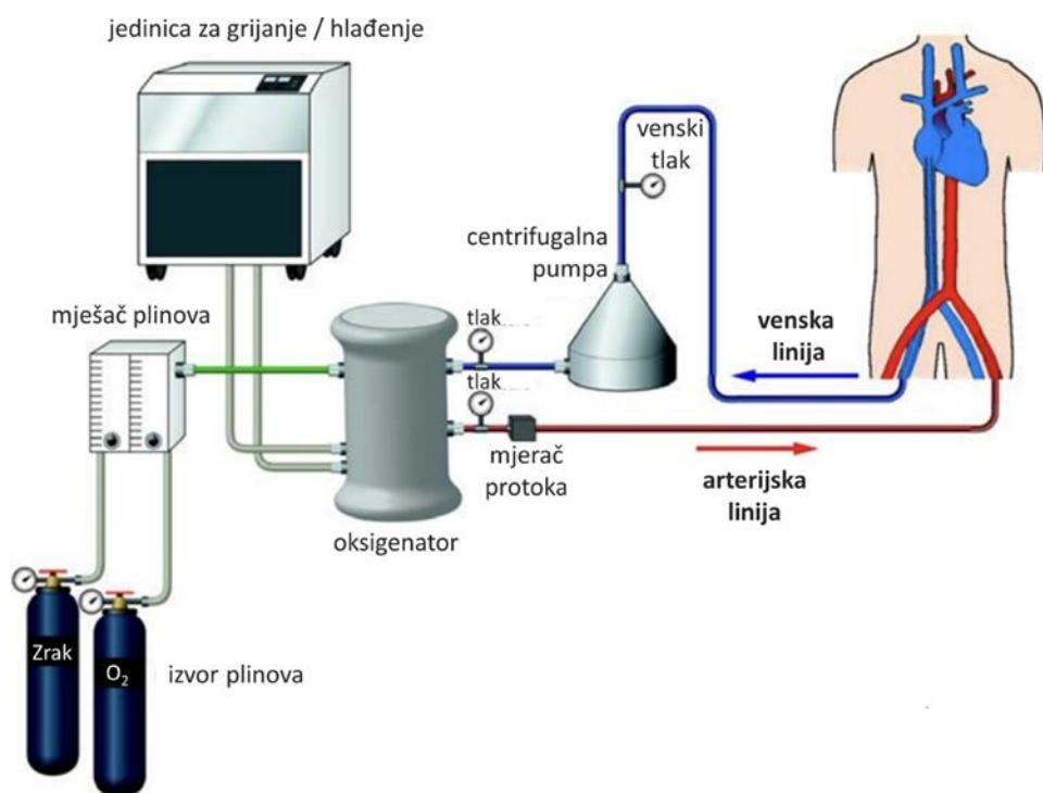
**Slika 5** Dijelovi ECMO sustava
