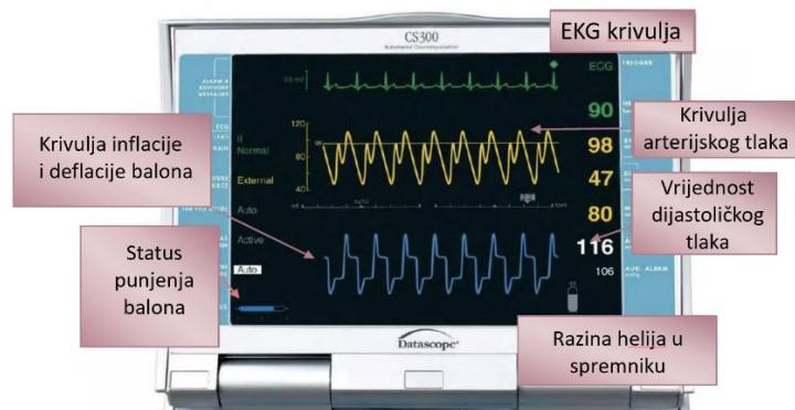
**Slika 1.** Prikaz monitoriranih parametara na IABP konzoli
