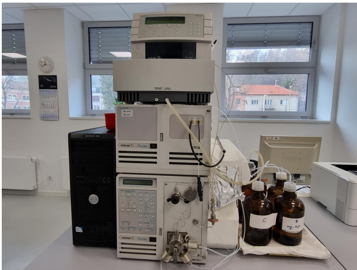
Slika 4.9. Tekućinski kromatograf visoke djelotvornosti s pumpom ProStar 230 SDM , UV-detektorom s nizom fotodioda i automatski uzorkivačem AutoSampler 410 , Varian, Walnut Creek, CA, SAD opremljen s kromatografskom kolonom Discovery HS F5 (15 cm × 2,1 mm, veličina čestica 5 μm), Supelco, Bellefonte, PA, SAD i pretkolonom Gemini C 18 (4 × 3 mm, veličina čestica 5 μm), Phenomenex, Torrance, CA, SAD
