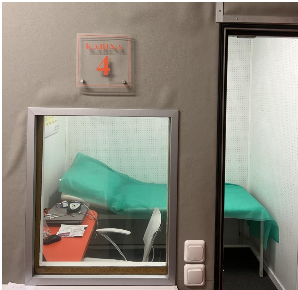
Slika 4.1. Kabina za ispitivanje evociranih slušnih potencijala moždanoga debla (fotografirano uz dopuštenje voditelja Audiološko-fonijatrijskog dijagnostičko-terapijskog odjela Klinike za otorinolaringologiju i kirurgiju glave i vrata Kliničkog bolničkog centra Sestre milosrdnice u Zagrebu)
