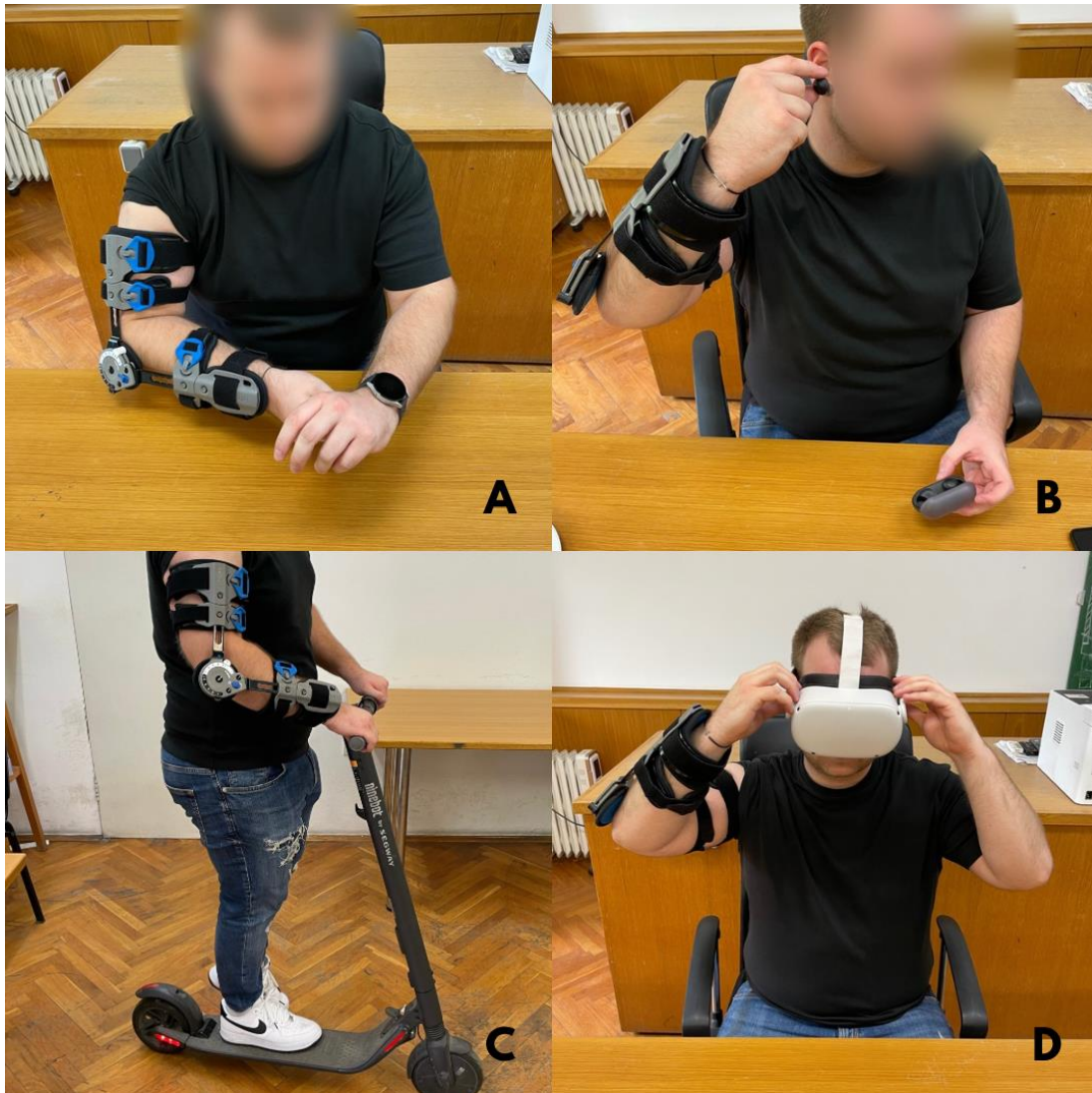
Slika 6. Ispitivanje suvremenih svakodnevnih aktivnosti - A) namještanje pametnog sata na suprotnu ruku; B) postavljanje pametnih slušalica u uho iste strane; C) stajanje na električnom romobilu; D) postavljanje naočala za virtualnu i proširenu realnost na glavu.
