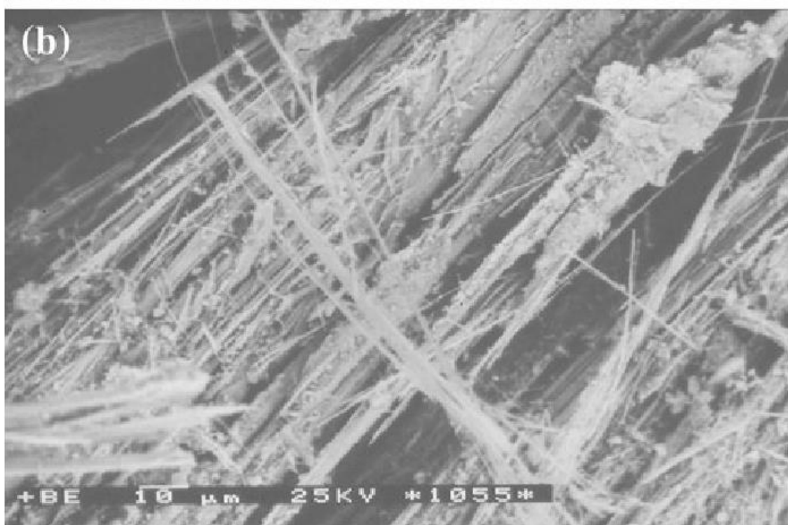
Slika 1 Prikaz razlika u strukturi vlakana između krizotila a) i krocidolita b) skenirajućim elektronskim mikroskopom. Slika preuzeta iz rada „Thermal decomposition of asbestos-containing materials“ uz dozvolu autora (10).
